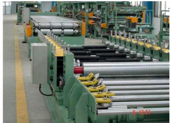
4. Один комплект корпуса производственной линии для сэндвич панелей с металлическим тепло-изоляционным покрытием.
